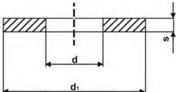
Kroužky těsnící ploché jsou vyráběny z : mědi, hliníku, zetalu, korozivzdorné oceli, vulkanfíbru a bezazbestových těsnících materiálů - jak v rozměrech dle normy ČSN 02 9310 ( DIN 7603-A), tak i v rozích mimo tuto normu.
